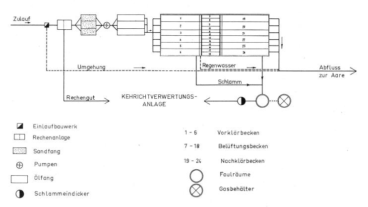
Abb. 3. Schemaplan der Kläranlage Biel.
