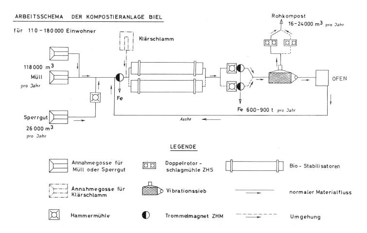
Abb. 4. Schemaplan der Müllverwertungsanlage Biel.
