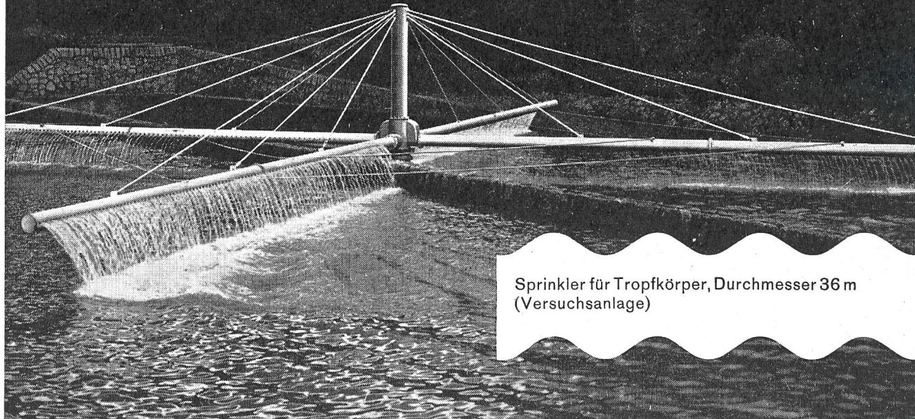
Sprinkler für Tropfkörper, Durchmesser 36 m
