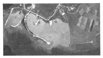
Abb. 3. Kiesausbeutung am obern Zürichsee, linkes Ufer. Die Baggerfirmen sind verpflichtet, Baggerbuchten durch Wiederinstandstellung des ursprünglichen Strandgürtels vom See abzuschliessen. (Aufnahme der Eidg. Landestopographie.)
