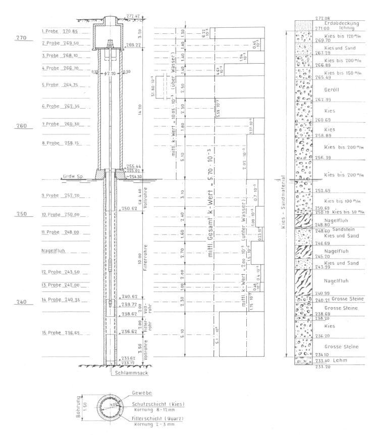
Schnitt durch Filterrohr
