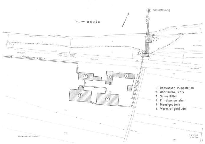
Abb. 2. Situationsplan von Rohwasserfassung und Aufbereitungsanlage.
