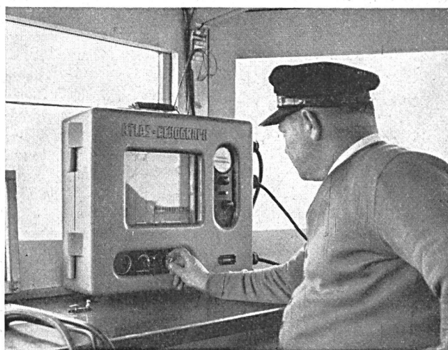
Fig. 8. L'appareil d'ultrason installé au poste de commandement du bateau, indique continuellement la profondeur de l'eau au-dessous du bateau.
