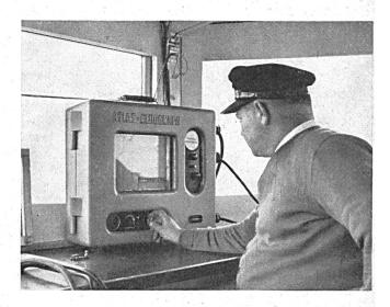
Fig. 8. L'appareil d'ultrason installé au poste de commandement du bâteau, indique continuellement la profondeur de l'eau au-dessous du bâteau.
