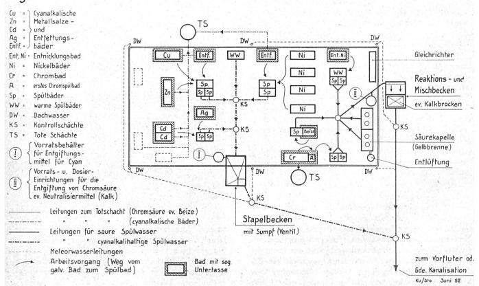
Abb. 9. Schema für die Entwässerung und Abwasserbehandlung von Galvanisieranstalten.
