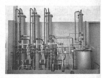
Abb. 12. Ionenaustauschanlage zur Entsalzung alkalischer cyanidhaltiger Spülwasser.
