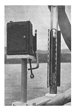
Abb. 2. Die Bohrkerne werden in einem Plexiglasrohr aufgeschnitten.
