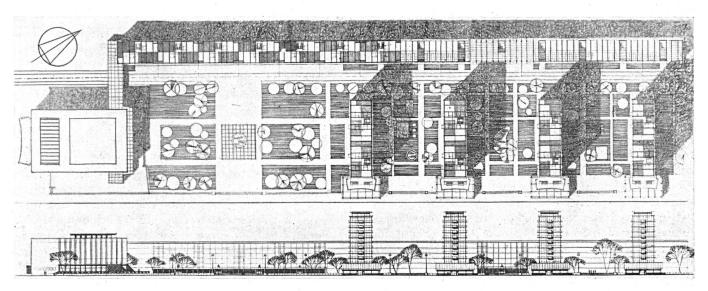
Abb. 8. Bratislava: Versuchssiedlung im Bau: Trockenmontage (Paneelbauten), Vogelperspektive und Aufriss.
