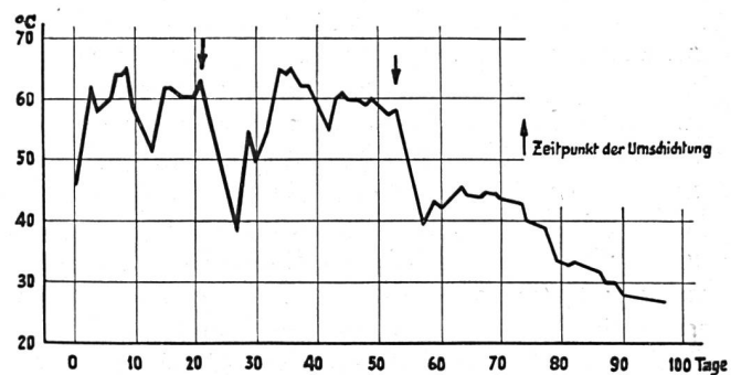
Abb. 4. Temperaturverlauf der Verrottung in einer Kompostmiete in 0,5 m Tiefe.
