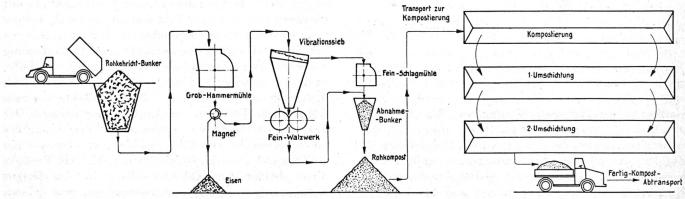
Abb. 2. Diagramm der Kehrichtverwertungsanlage System Bühler.
