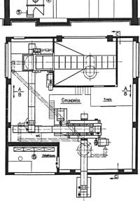
Abb. 3. Müllverwertungsanlage Uzwil. Aufriss und Grundriss.
