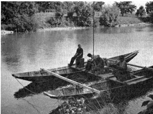
Abb. 4. Wassermessung mit hydrometrischem Flügel von Schiffen aus.
