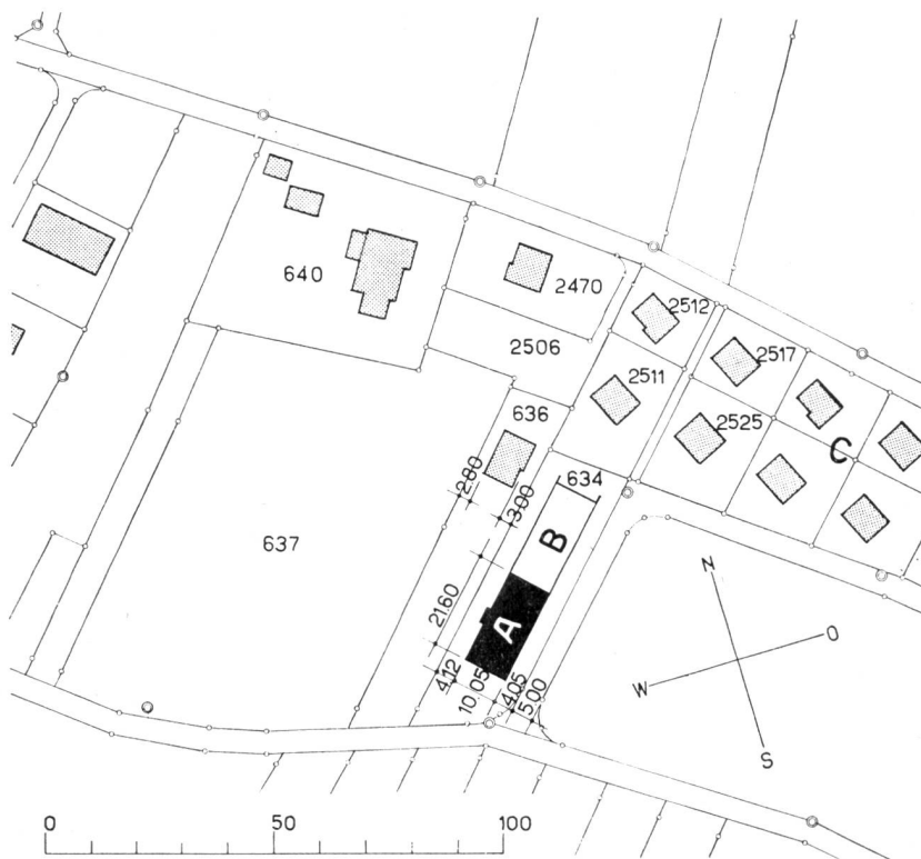
Abb. 1. Situationsplan 1:1000. Das Hochhaus A mit einer Grundfläche von rd. 10 \times 21 m und den angebauten Garagen B steht auf einer Terrasse südwestlich der anderthalbgeschossigen Einfamilienhäuser C, die vom gleichen Architekten projektiert wurden. Das Hochhaus weist vom nichtausgebauten Zugangsweg mit 5 m Breite einen Abstand von 4,05 m auf. Der Grenzabstand zur nachbarlichen Liegenschaft beträgt 4,12 m. Weder in bezug auf die Eingliederung ins Ortsbild noch in bezug auf die Erschliessung noch auf die Auswirkung auf die unmittelbare Nachbarschaft ist das Projekt studiert. Neben den vollkommen fehlenden Parkierungsmöglichkeiten wurden weder für die Sicherheit der Passanten (Stabgeländer der Balkone gegen die Strasse) noch für die Sicherheit der Bewohner genügende Massnahmen getroffen.
