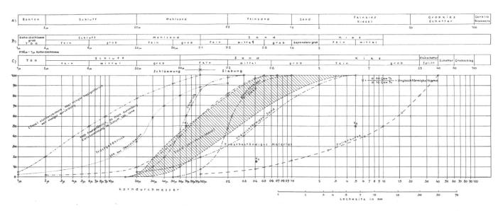
Abb. 1. Darstellung der Korngrössenverteilung von Böden. Fraktionseinteilung nach: A) dem Entwurf der ÖNORM B 3150, Benennung der Bodenarten für bautechnische Zwecke; B) einer früheren Auffassung; C) praktischen Bedürfnissen des Strassenbaues.
