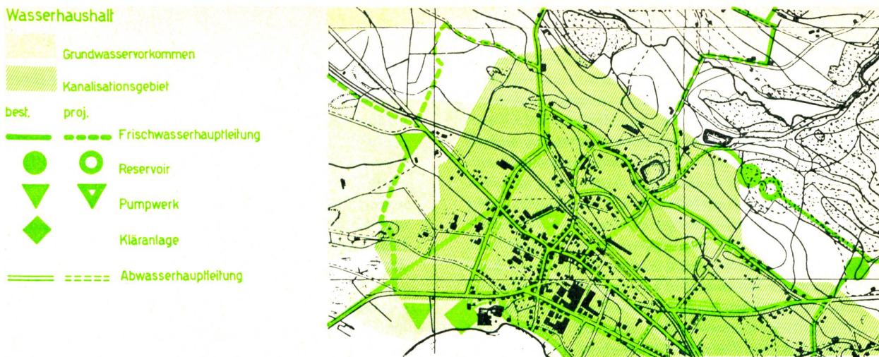
Abb. 3. Planung von Trinkwasser- und Abwasseranlagen.
