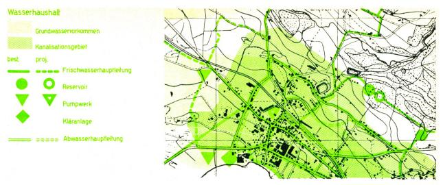
Abb. 3. Planung von Trinkwasser- und Abwasseranlagen.
