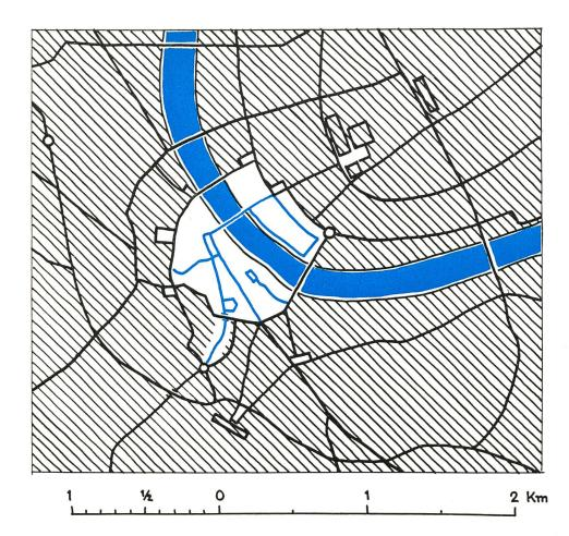
Abb. 2. Basel. Zweite Etappe der Fussgängerstadt. Nach dem Bau der Totentanzbrücke kann nun auch die rechtsufrige Altstadt mitsamt der Mittleren Rheinbrücke dem Fussgängerverkehr vorbehalten werden. Ebenso wird nun die Steinenvorstadt vom Fahrverkehr befreit: an der Kreuzung beim Stadtkasino wird die Ringstrasse über den Verkehrszug Gerbergasse/Steinenvorstadt hinweggeführt.
