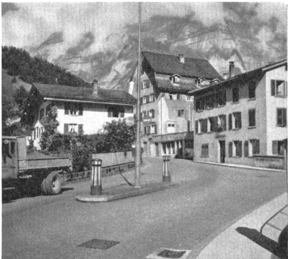
Abb. 4. Zweifelhafte Verkehrslenkung: Die Hauptstrasse führt nach links weiter; solche Schutzinseln erschweren den Verkehr.
