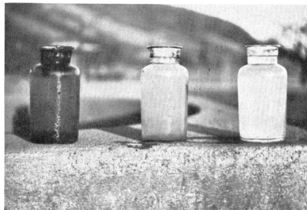
Abb. 12. Rohwasser, entöltes Abwasser, Abfluss des Nachbelüftungsweihers.
