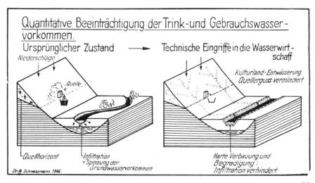
Abb. 4. Schematische Darstellung der quantitativen Beeinträchtigung von Trink. und Gebrauchswasservorkommen als Folge technischer Eingriffe in die Wasserwirtschaft.
