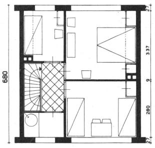
Abb. 5. Obergeschoss-Grundriss zu Abb. 4.
