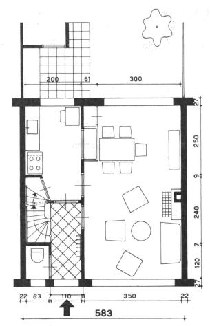
Abb. 4. Typischer Grundriss eines holländischen Reihen-Einfamilienhauses. Im Erdgeschoss ist der grosse Wohnraum quergestellt.
