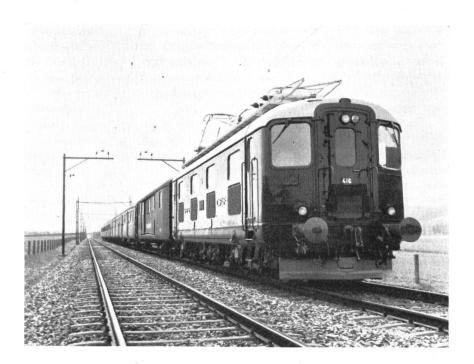
Abb. 1. Leichtschnellzug im Mittelland mit Lokomotive Re 4/4.
