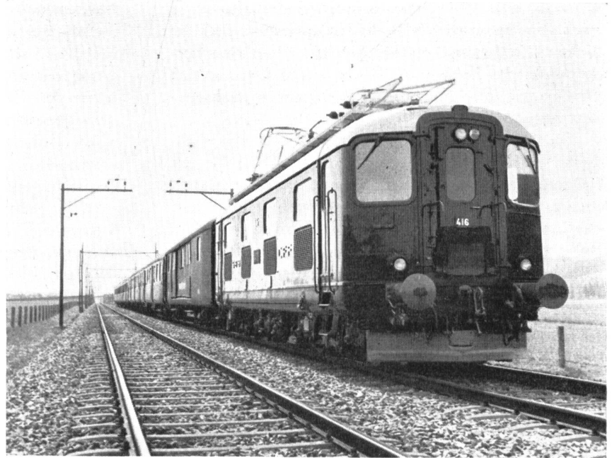
Abb. 1. Leichtschnellzug im Mittelland mit Lokomotive Re 4/4.
