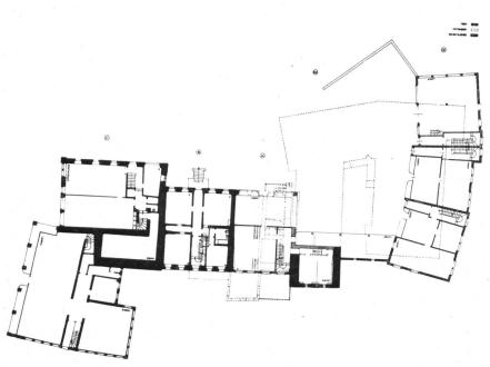
Abb. 4. Projektierte Sanierungsmassnahmen.
