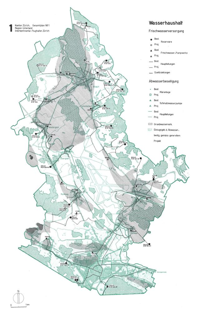
Abb. 49. Die Beschaffung von Frischwasser und die Beseitigung des Abwassers müssen naturgemäss miteinander studiert werden, damit nicht durch gegenseitige Einwirkungen schädliche Störungen des Gleichgewichtes entstehen.
