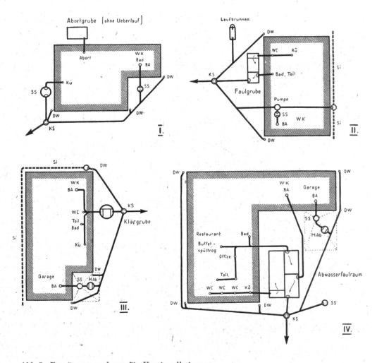
Abb. 5. Entwässerungsschema für Hausinstallationen.
