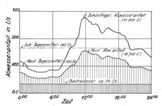
Abb. 1. Abflussdiagramm an einem Tag mit max. Brauchwasseranfall und geringer Bachwassermenge (16. August 1948).
