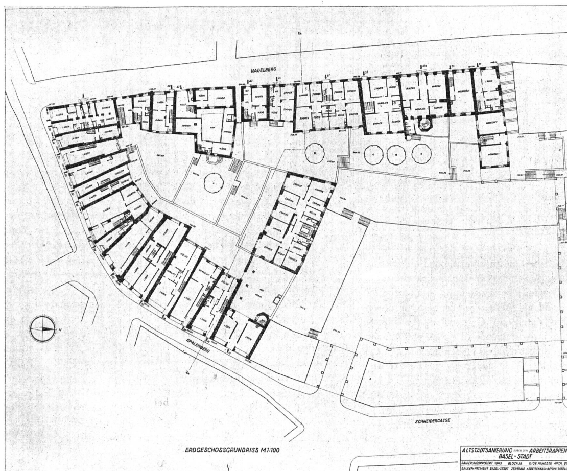
Abb. 17. Erdgeschossgrundriss Block 3a, südlicher Teil, nach der Sanierung.
