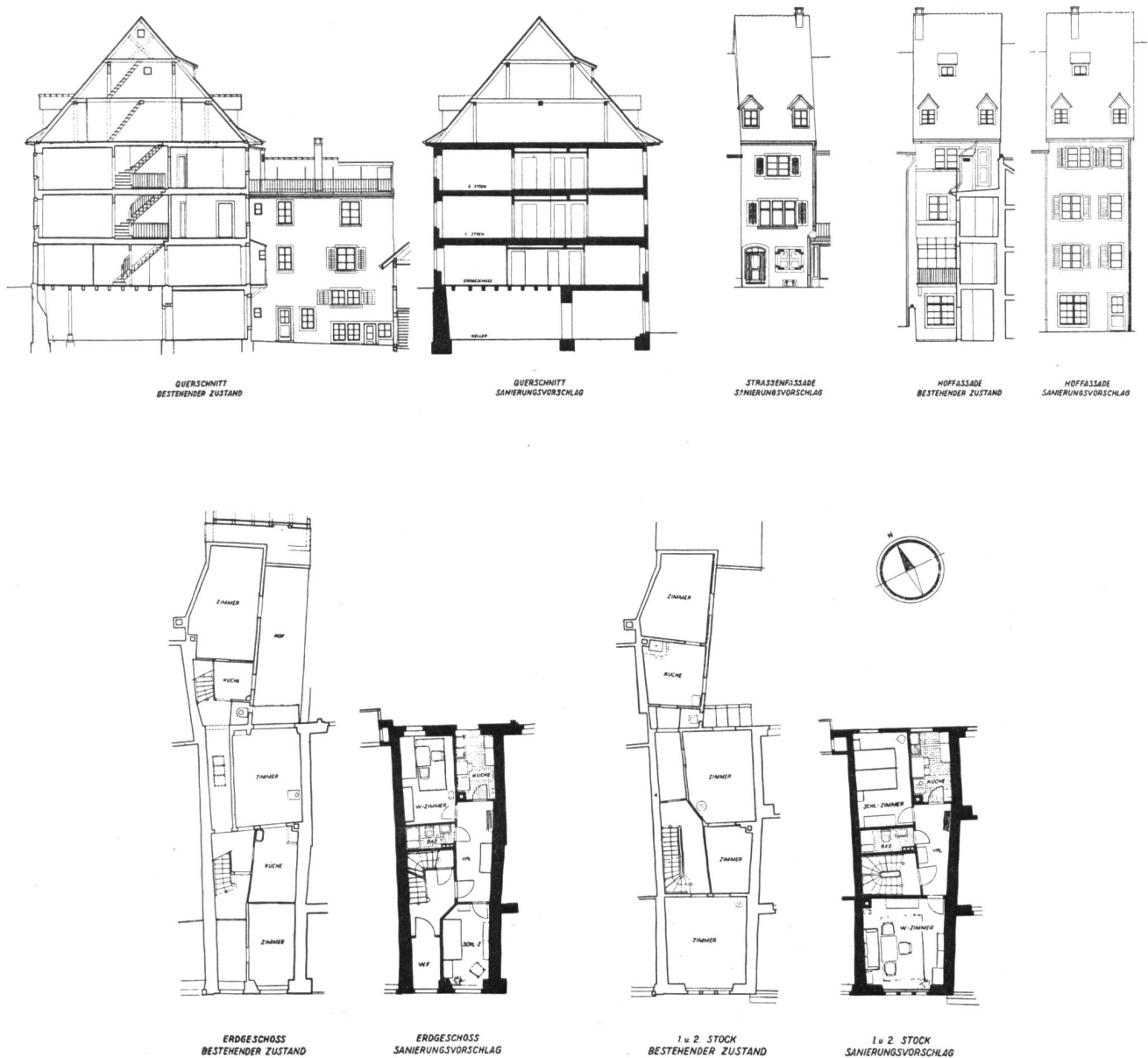
Abb. 15. Teilgebiet, Block 3a. Schnitte, Fassaden und Grundrisse einzelner Häuser vor und nach Sanierung.
