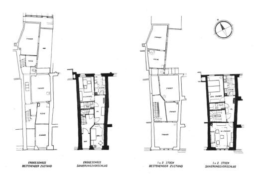
Abb. 15. Teilgebiet, Block 3a. Schnitte, Fassaden und Grundrisse einzelner Häuser vor und nach Sanierung.
