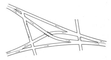
Abb. 15. Amerikanische Ausbildung einer Strassengabel mit Kreuzungsbauwerk am meistbelasteten Schnittpunkt, ähnlich Abb. 12.
