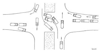
Abb. 8. Die Trennung der Fahrbahnen von Hauptstrassen durch einen breiten Mittelstreifen erleichtert das gefährliche Abbiegen nach links in die Nebenstrasse.
