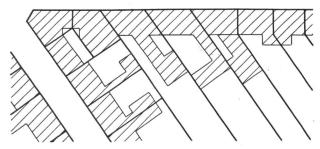
Abb. 2. Einfluss der Baulandeinteilung auf die Grundrissgestaltung.
