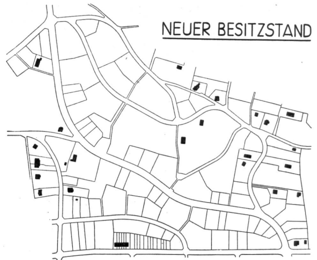
Abb. 4. Grundstückeinteilung nach durchgeführter Baulandumlegung.
