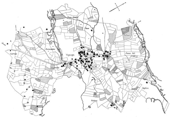
Abb. 1. Güterzusammenlegung in der Gemeinde Vigens (Kanton Graubünden). Alter Besitzstand. Horizonal schraffiert: Besitz des Bauern A; vertikal schraffiert: Besitz des Bauern B; schräg schraffiert: Besitz des Bauern C.
