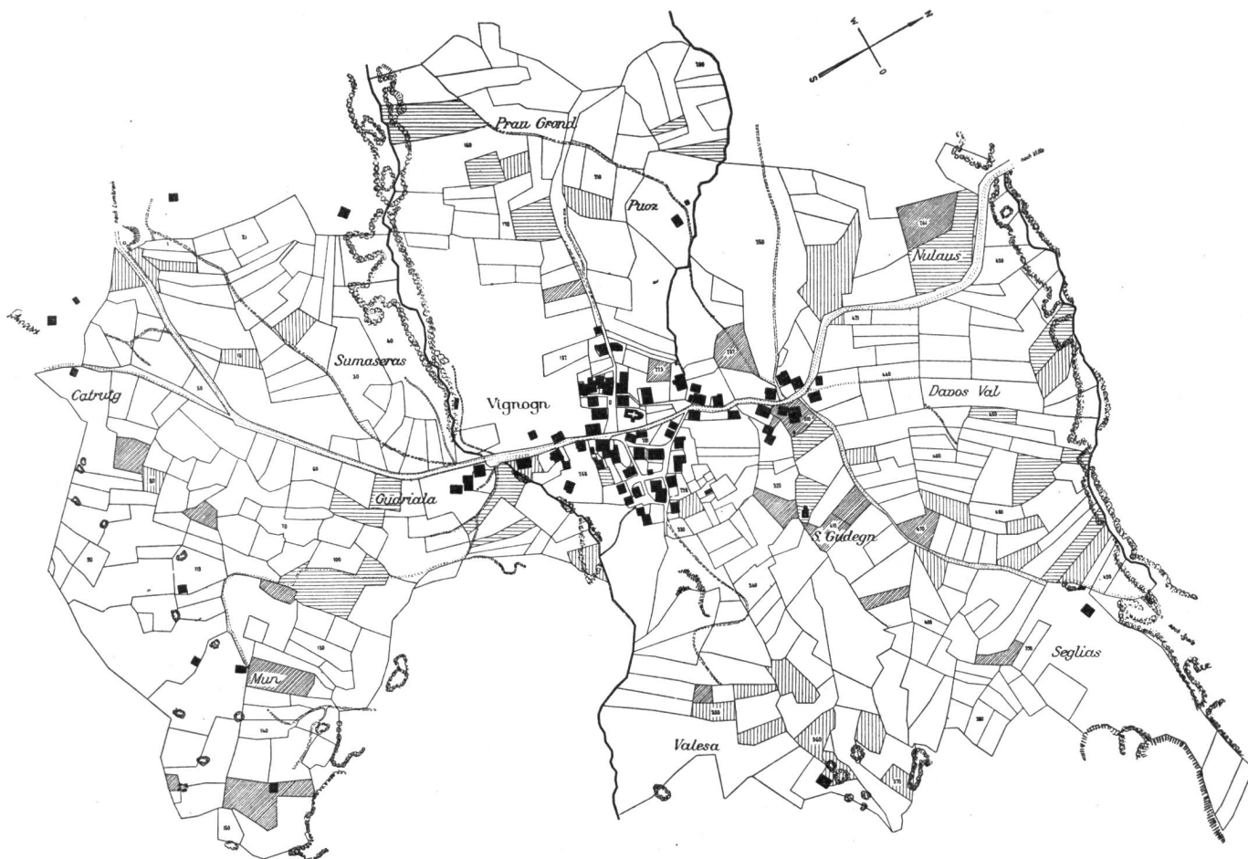
Abb. 1. Güterzusammenlegung in der Gemeinde Vigens (Kanton Graubünden). Alter Besitzstand. Horizontal schraffiert: Besitz des Bauern A; vertikal schraffiert: Besitz des Bauern B; schräg schraffiert: Besitz des Bauern C.
