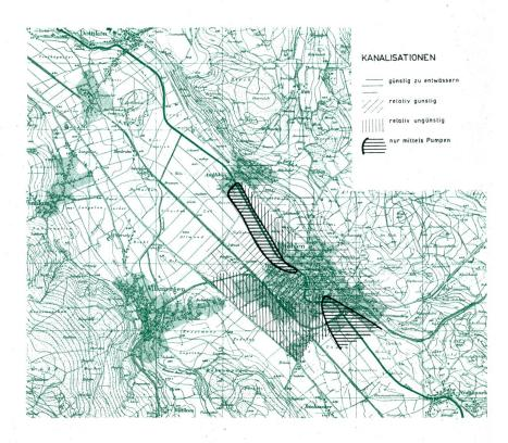
Abb. 4. Schematische Darstellung der Entwässerungsmöglichkeiten in der Gegend von Wohlen.
