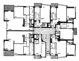
Abb. 2. Typischer Punkthausgrundriss.
