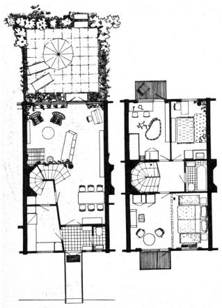
Abb. 10. Reihenhäuser aus Stockholm (Grundrisse zu Abb. 8).
