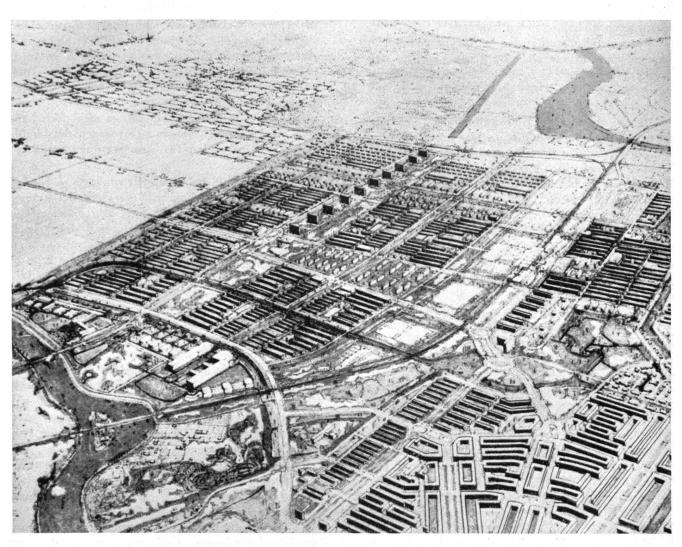
Abb. 3. Projekt aus einer mustergültig organisierten Stadtplanung aus Holland. Der geschlossene Stadtkern geht über zum offenen Zeilenbau, vermischt mit einzelnen Hochhauspartien. Am Rande sind die eigentlichen Flachbausiedlungen placiert, die das dem Boden verbundene ideale Wohnen ermöglichen. Der ganze Stadtteil ist durchzogen von Wasserläufen und Grünflächen für Erholung und Sport.
