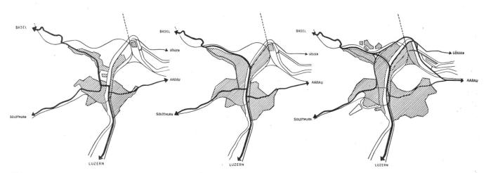
Abb. 5. Projekt 8 (Ankauf). Typisches Projekt mit Strasse 2 via Bahnhofplatz und neue Aarebrücke. Der Streifen zwischen Bahn und Aare ist zu schmal, als dass mit einfachen Mitteln die notwendige Trennung des Durchgangs- vom Lokalverkehr durchgeführt werden könnte. — Links: Bestehender Zustand. Mitte: Erste Etappe nach Erstellung der Strasse 2. Rechts: Zweite Etappe, nach Erstellung einer nördlichen Umfahrungsstrasse (siehe hiezu Bericht der Jury zu Strasse 5).
