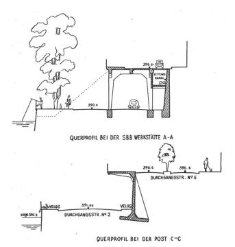
Abb. 6. Projekt 9 (Ankauf). Ein weiteres Projekt mit Strasse 2 via Bahnhofplatz. Hier wird mit grossem baulichem Aufwand versucht, die Schwierigkeiten beim Bahnhofplatz zu überwinden: Zweigeschossige Strasse mit Trennung des Durchgangsverkehrs vom Lokalverkehr. Nachteile: Das ganze rechtsseitige Aareufer wird zum betonierten Uferquai; was aber ausschlaggebender: Kein Anschluss des lokalen Strassennetzes an den Durchgangsverkehr möglich.
