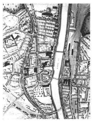
Abb. 4. Projekt 12, Vorschlag für Strasse 2, mit Durchfahrung der linksufrigen Stadt. Die Eingriffe in den Baubestand gehen sehr weit. Die hohen Kosten stünden in keinem Verhältnis zum Erreichten. Man beachte die vielen Kreuzungen und Einmündungen, die für den Durchgangs- wie für den Lokalverkehr hinderlich sind.
