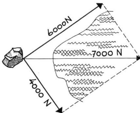
Mit Hilfe eines Kräfteparallelogramms kann man auch Kräfte **zerlegen**.
