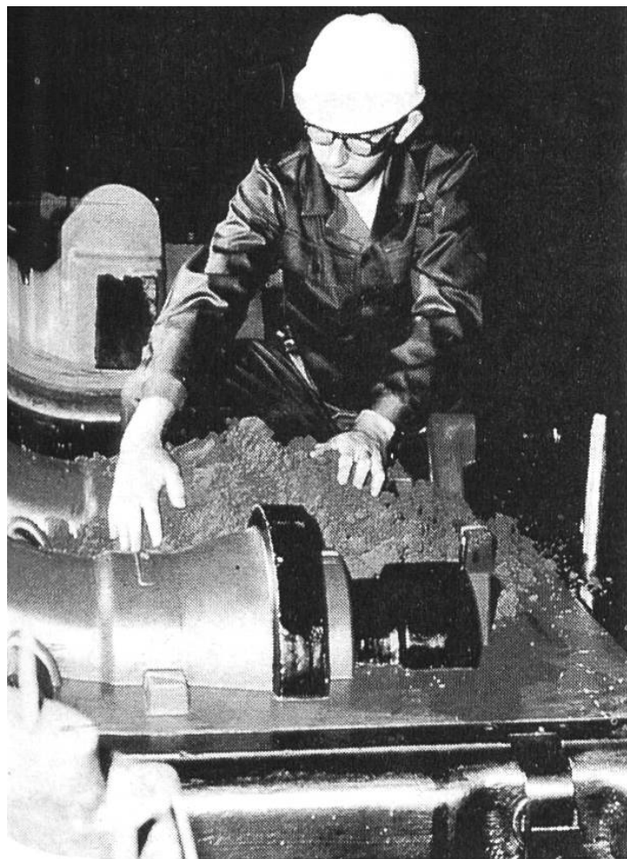
Modell und Sand sind die wichtigsten Teile zur Herstellung der Gussform.
