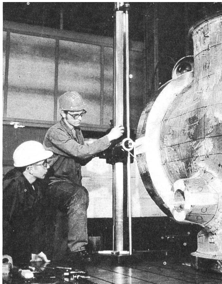
In der Kontrolle wird das Gussstück auf die Richtigkeit der vorgeschriebenen Masse kontrolliert und angerissen.
