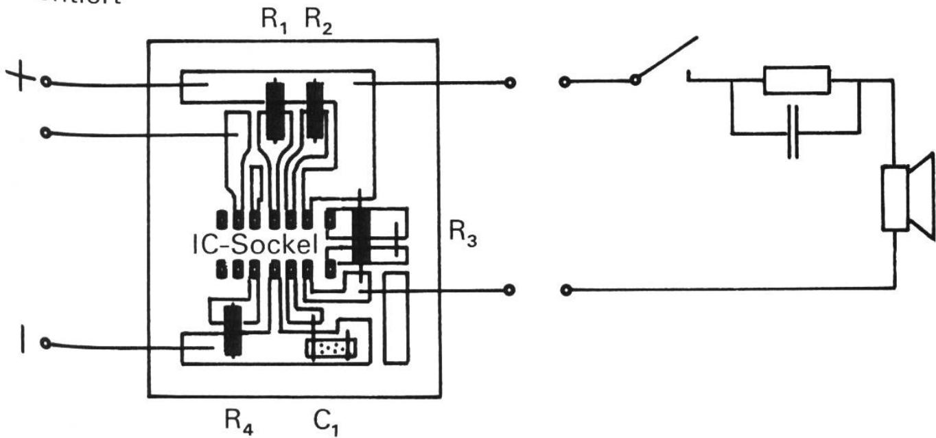
Nach dem Schalt- und Bestückungsplan setzest du die wenigen Widerstände und den Kondensator auf die Printplatte, schliesst Batterie, Taste und Kopfhörer (oder Kleinlautsprecher) an, und schon kann's losgehen.
