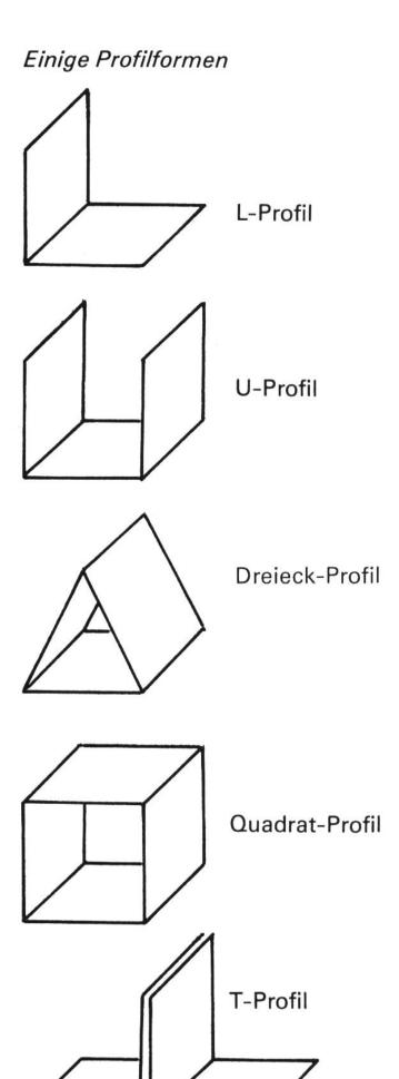
Mit dem gerundeten Scherenrücken werden die Biegefälze gezogen. Längs einem Massstab oder einer Reissschiene biegen wir den Streifen alsdann rechtwinklig auf. Wir achten auf saubere, scharfe Biegekanten. Dreieckund Quadrat-Profile werden auf einer Bahn in Längsrichtung verleimt.
