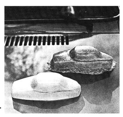
Nachbearbeitung: Die Rohkarosserie wird durch Schneiden und durch Bearbeitung mit Schleifpapier in die endgültige Form gebracht. Nach Abdeckung der Flächen kann sie farbig gespritzt werden.
