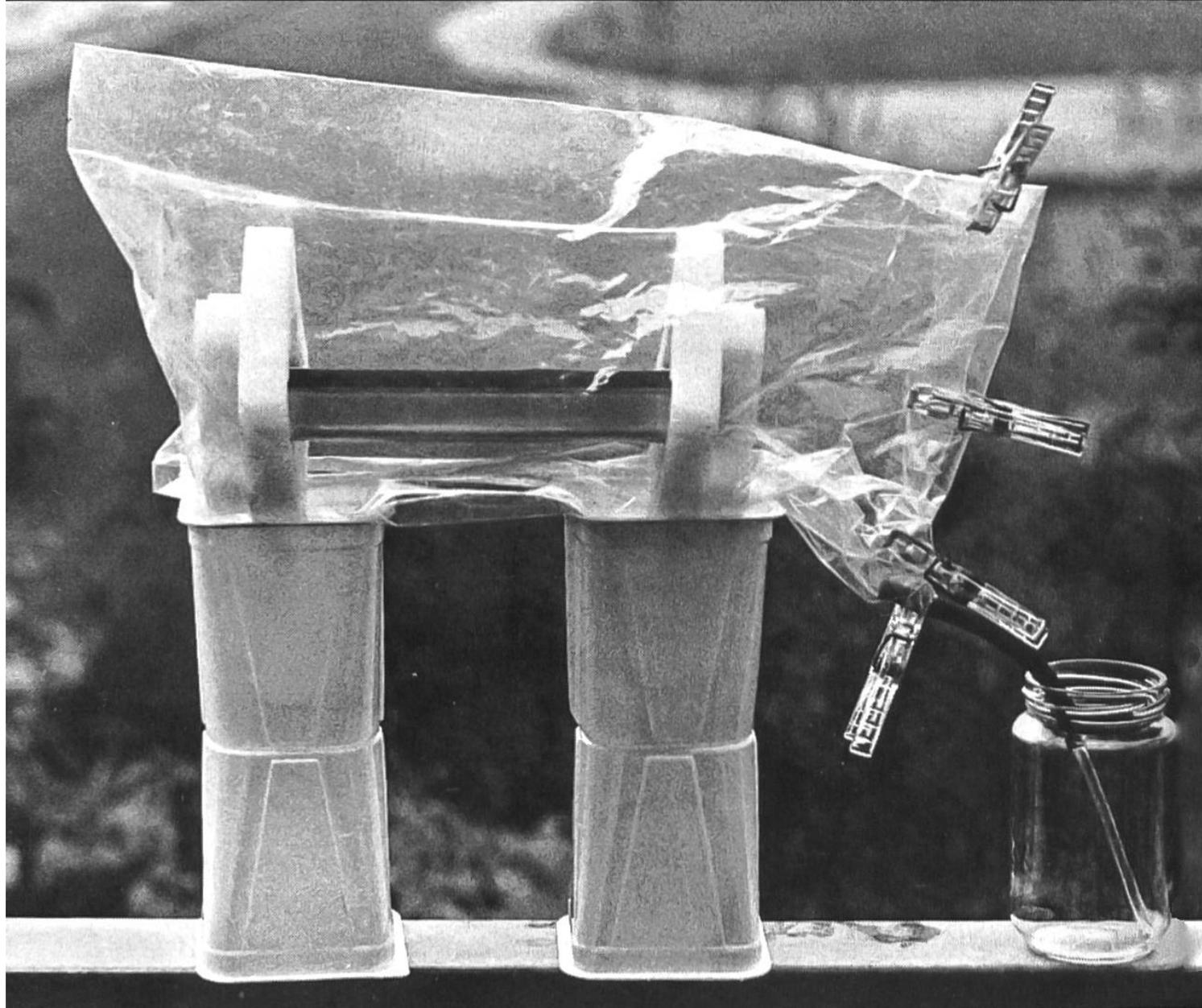
nenenergie zu verwenden. Um aus der Strahlung möglichst viel Wärme zu ziehen, färben wir eine flache Aluminiumschale mit schwarzem Mattlack ein. Passende Behälter werden in Kühlschränken zur Bereitung von Eiswürfelchen verwendet – sie lassen sich in Haushaltsgeschäften für wenig Geld nachbeziehen, als Behelf für unverbindliche Experimente können jedoch auch die billigen Kuchenformen aus Alufolie dienen.
