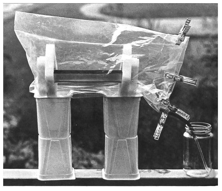
nenenergie zu verwenden. Um aus der Strahlung möglichst viel Wärme zu ziehen, färben wir eine flache Aluminiumschale mit schwarzem Mattlack ein. Passende Behälter werden in Kühlschränken zur Bereitung von Eiswürfelchen verwendet – sie lassen sich in Haushaltungsgeschäften für wenig Geld nachbeziehen, als Behelf für unverbindliche Experimente können jedoch auch die billigen Kuchenformen aus Alufolie dienen.
