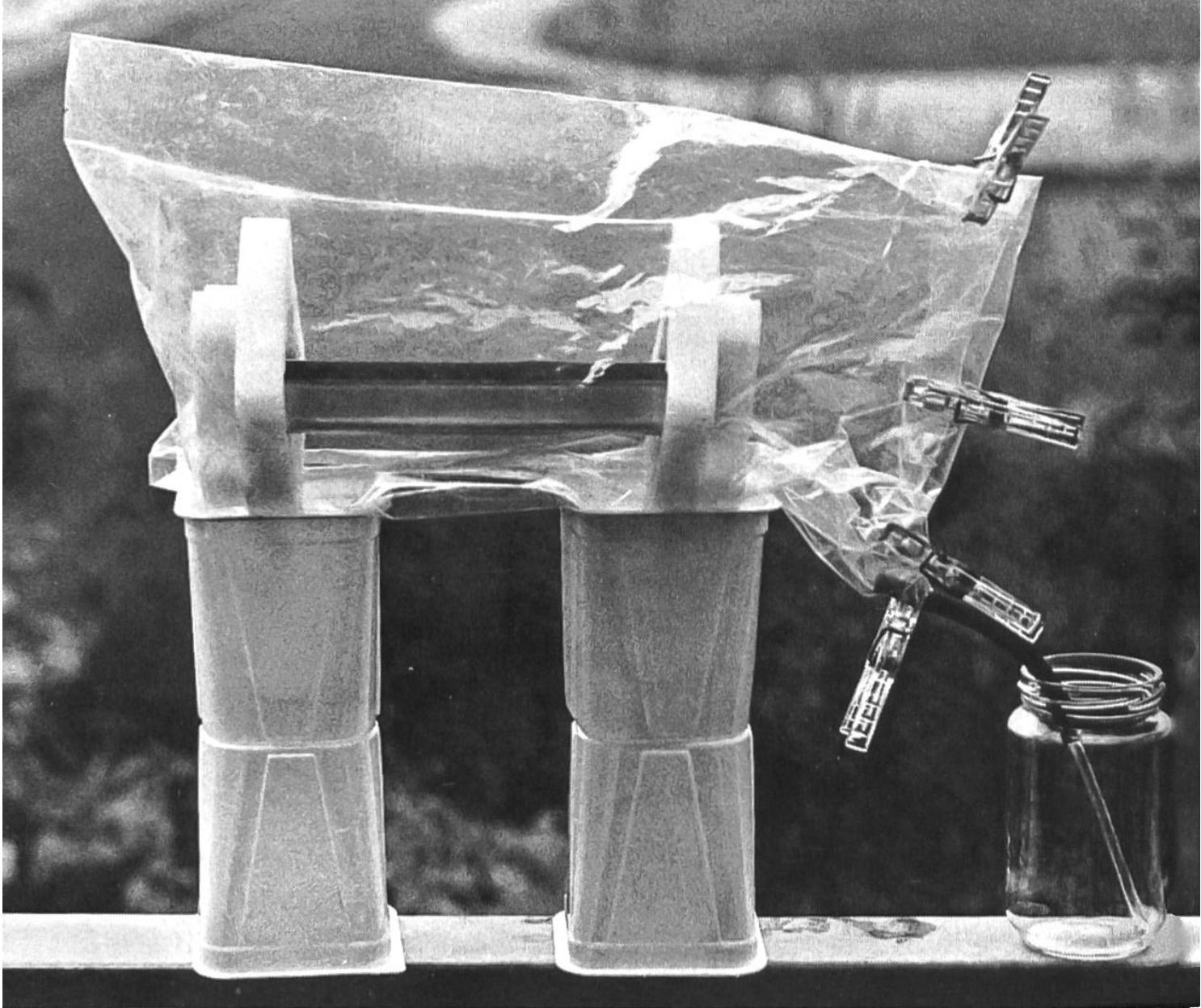
nenenergie zu verwenden. Um aus der Strahlung möglichst viel Wärme zu ziehen, färben wir eine flache Aluminiumschale mit schwarzem Mattlack ein. Passende Behälter werden in Kühl-schränken zur Bereitung von Eiswürfelchen verwendet – sie lassen sich in Haushaltungs-geschäften für wenig Geld nach-beziehen, als Behelf für unver-bindliche Experimente können je-doch auch die billigen Kuchenfor-men aus Alufolie dienen.
