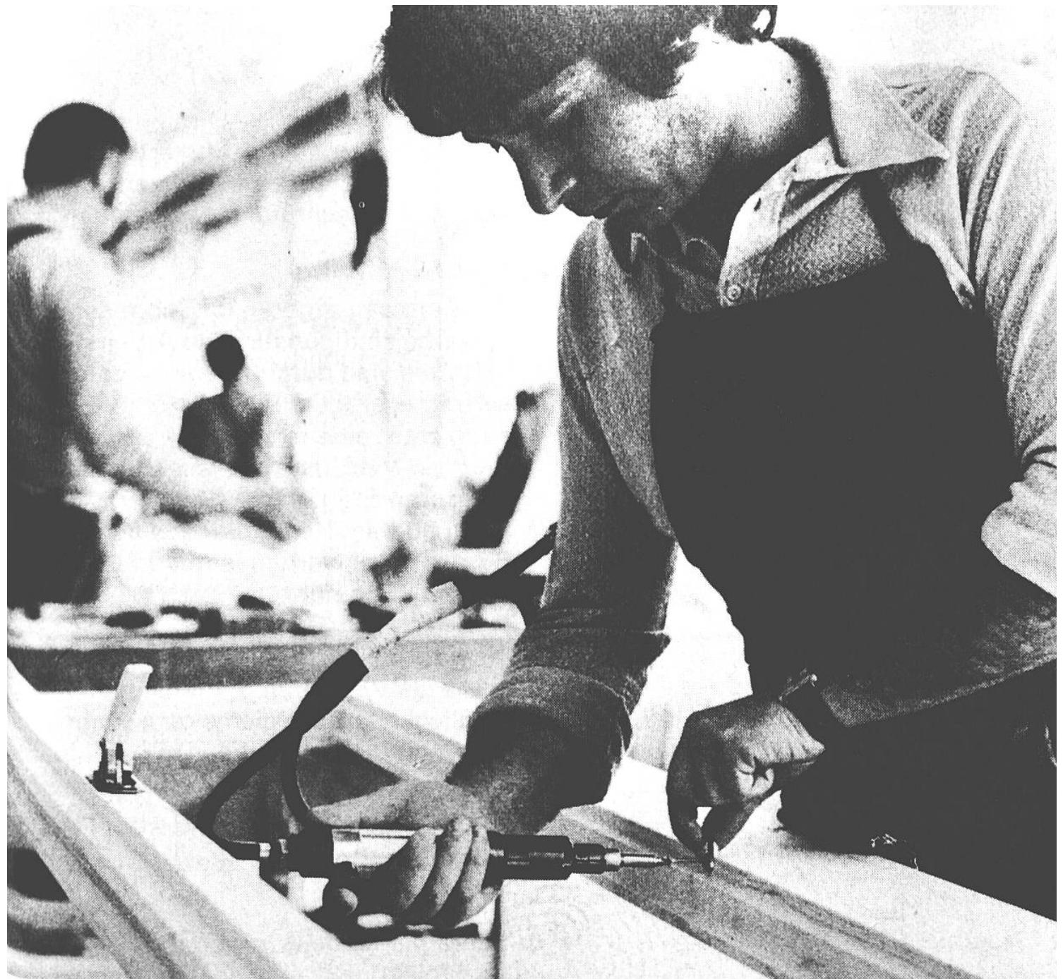
*Das Montieren von Beschlägen erfolgt mit Hilfe elektrisch oder pneumatisch betriebener Geräte, wie Bohrer, Schraubendreher usw.*
