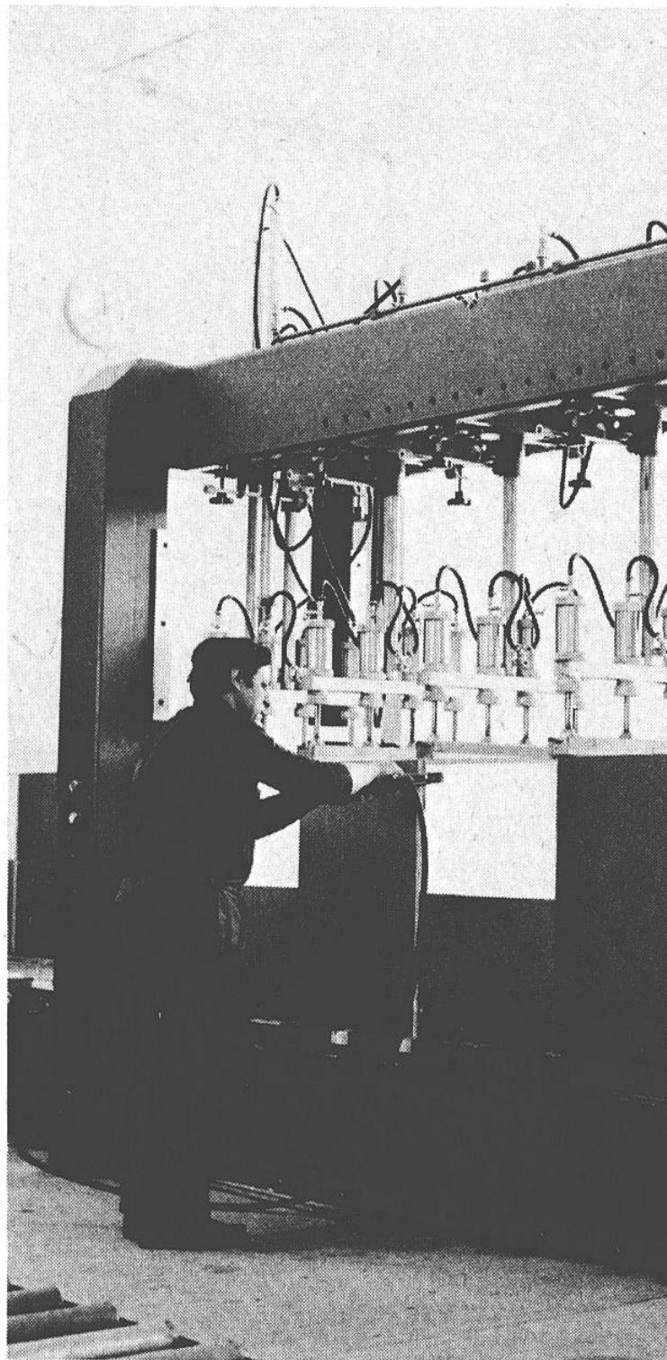
*Auch für das Verleimen der fertig bearbeiteten Einzelteile zu Möbelkörpern stehen maschinelle Einrichtungen zur Verfügung.*
