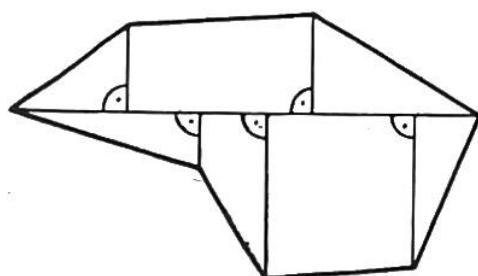
b. mit einer passenden Diagonale und auf dieser rechtwinklig errichteten Höhen zu den Ecken in Dreiecke und Trapeze, berechnet diese Teile einzeln und addiert die Teilresultate.
