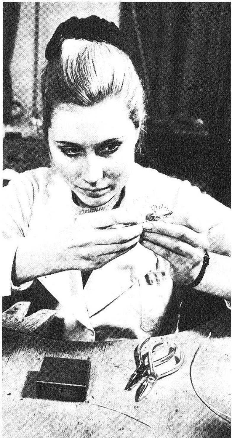
darauf achten, dass wenig Abfall entsteht. Dann bearbeitet sie das Edelmetall auf seine zukünftige Form durch Schmelzen, Giessen, Biegen, Sägen, Bohren, Fräsen, Feilen, Löten, Montieren der dazugehörigen Steine und schliesslich Polieren.
