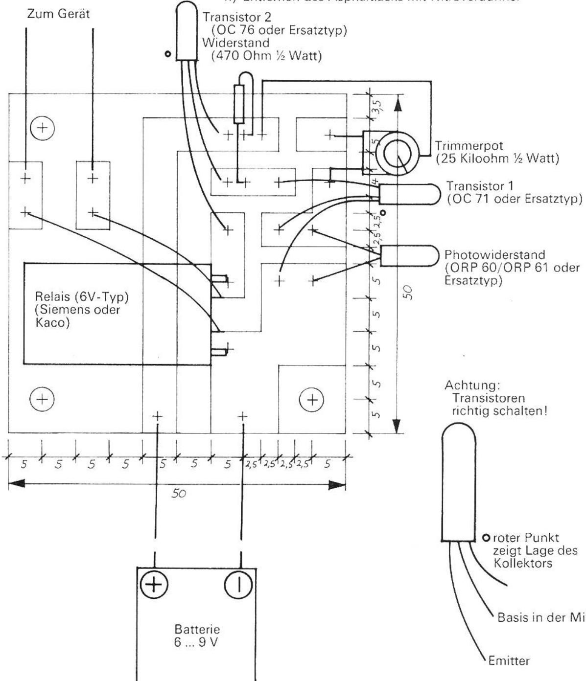
Die Kreuze (+) bezeichnen jene Punkte, wo eine Bohrung anzubringen ist. Normalerweise genügt zur Durchführung der Anschlussdrähte ein Lochdurchmesser von 1-1½ mm. Die Löting der Bauteile soll mit sehr heißem Lötkolben mit feiner Spitze und unter Verwendung von Spezialzinn erfolgen. Da Transistoren und Photowiderstände sehr wärmeempfindlich sind, fasse man während der Verlötzung die Zuleitungsdrähte fest mit einer Pinzette oder mit einer feinen Zange; dadurch wird die Hitze abgeleitet.
