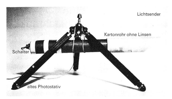
sich zusätzlich einen passenden «Sender», der einen Lichtstrahl zum elektronischen Auge schickt. Im einfachsten Falle wird dies eine Taschenlampe sein. Ihr Lichtkegel wird direkt auf den Photowiderstand gerichtet. Bündelt die Lampenlinse zu wenig scharf, so kann man versuchen, den Strahl mit Hilfe eines langen Kartonrohrs einzuengen. (Beachte dazu das Werkphoto!) Falls du noch höhere Ansprüche stellst, musst du auch vor den Photowiderstand eine passende Sammellinse setzen.
