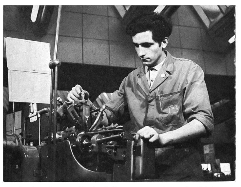
Der Decolleteur ist für eine Reihe von automatischen Drehbänken verantwortlich. Er führt deren Einstellung aus und überwacht die Produktion.
