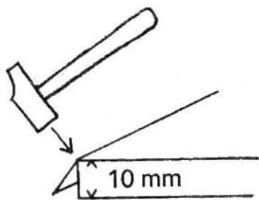
Weissblechrand wird mit einem Hammer 10 mm breit auf einer Eisenkante zurechtgeschlagen. Engmaschiges Drahtgitter wird mit Agraffen befestigt.
