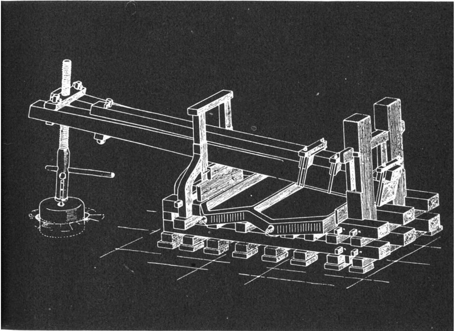
*Zwei Eichenbalken vor und hinter dem Trottbett geben dem Trottbau seitlich Führung. Vorne ist er gegabelt und trägt das Querholz. An einschiebbaren Querstangen dreht man die Spindel, bis der schwere Stein sich vom Boden hebt und den Druck über den Trottbau auf das Trottbett verstärkt.*
