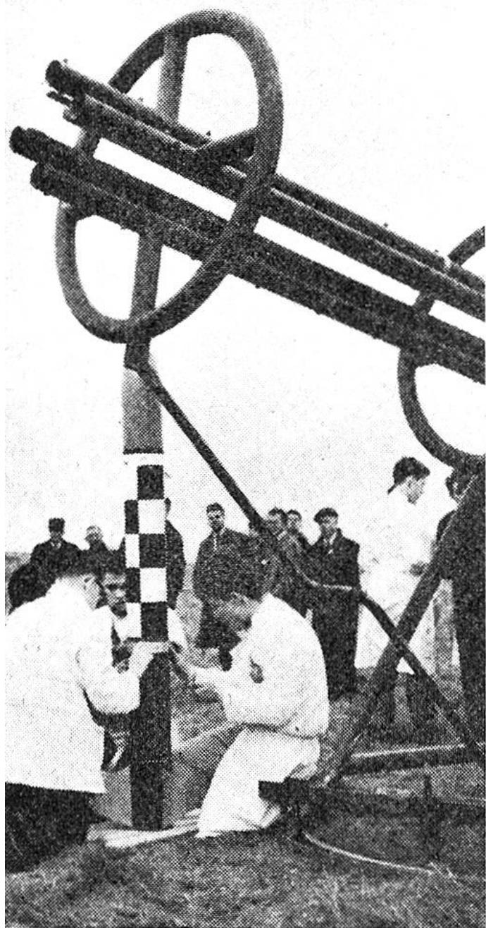
Kurz vor dem Start erst werden Raketenkopf und Antriebswerk zusammengesetzt. Gut erkennbar am Raketenkörper: die Stabilisierungsflügel.
