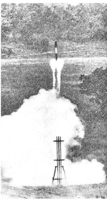
Kurz vor dem Start erst werden Raketenkopf und Antriebswerk zusammengesetzt. Gut erkennbar am Raketenkörper: die Stabilisierungsflügel.
