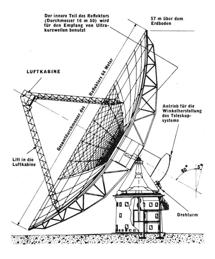
Die Hauptteile des Radioteleskops. Für die Untersuchungen muss der Reflektor mittels einer komplizierten Anlage auf eine bestimmte Stelle des Sternhimmels gerichtet werden können. Da sich wegen der Erddrehung die Himmelskörper ständig verschieben, wird die Stellung laufend automatisch jeder Verschiebung angepasst.
