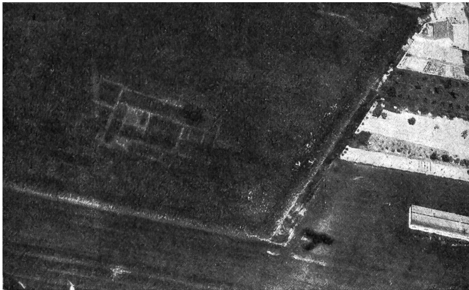
Abb. 3. Unterschiede im Pflanzenbewuchs. Im gleichmässig bewachsenen Feld bleiben einzelne Halme im Wuchs zurück. Sie haben wenig Nährboden, weil sie auf Mauerzügen wachsen. Römischer Gutshof mit Badeanlage und heizbaren Zimmern.
